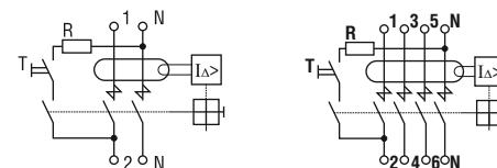
четырехполюсный выключатель / four-pole circuit-breaker
