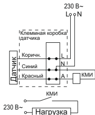
Рисунок 21 – Схема подключения датчика с контактором КМИ
