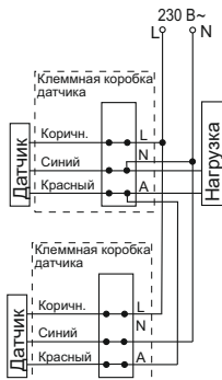
Рисунок 19 – Схема параллельного подключения датчиков
