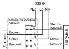
Рисунок 18 - Схема подключения датчика типа ДД 017
